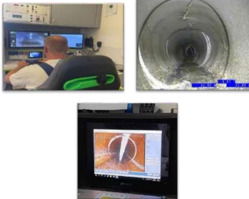
Figure 17.Rast se si kryhet inspektimi me kamerë robotike
