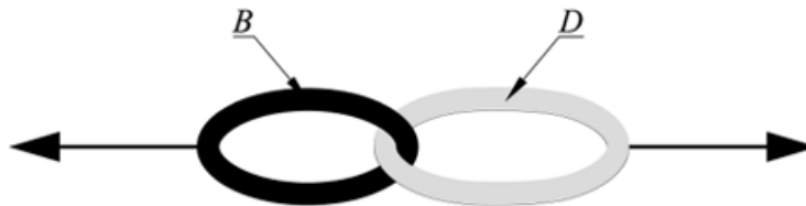
Fig 6. Projektimi sipas kapaciteteve – shembull i dy unazave (sistem në seri): B-e thyeshme, D-duktilë
