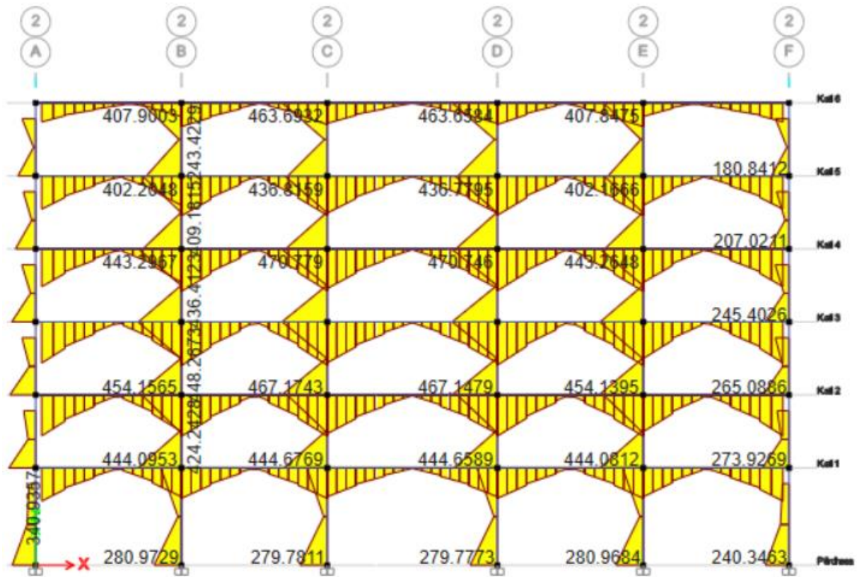
Figura xx– Diagrami i momenteve të përkuljes (M) në ramën 2-2 nga ngarkesat e Sizmike (Sx) në drejtimin global X të strukturës
