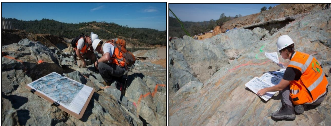
Figura 0.4. Hartimi gjeologjik i bazamentit të kapërderdhësit, nga vlersimi vizual (CDWR, 2017)
