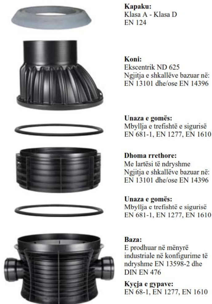
Figura 25. Puseta standarde (Romold GmbH, 2019), (përkthimi: anglisht – shqip)
