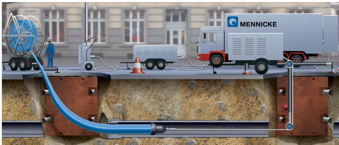
Figura 9. Instalimi i tubit të ri përmes metodës CFP (Rohrbau, 2013)
