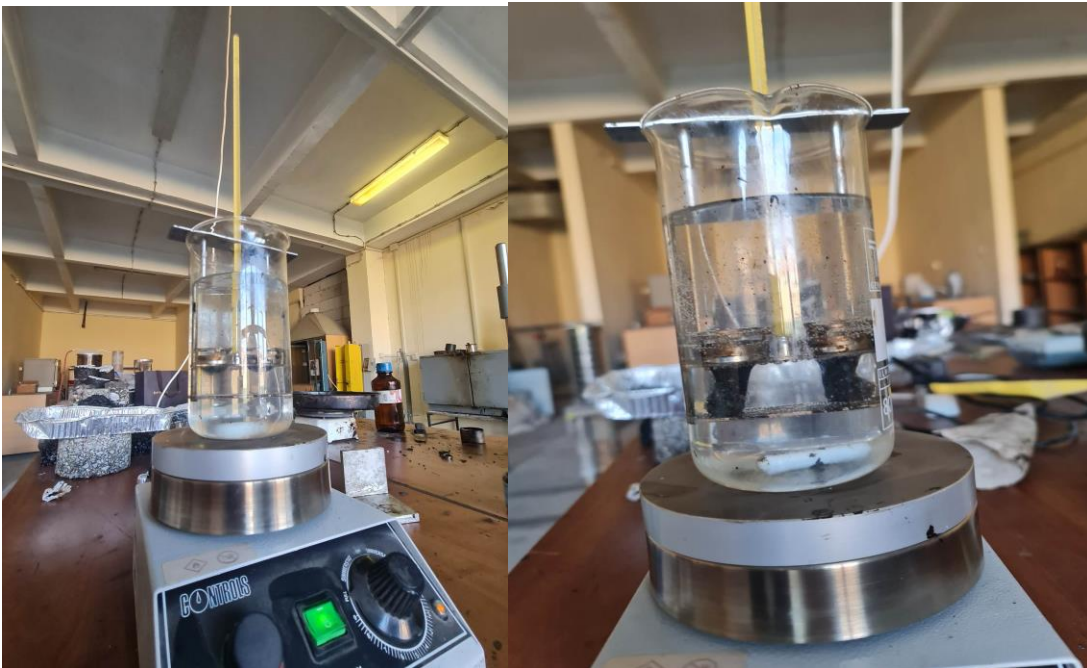
Fig.3.8 a) momenti i vendosjes se mostrave ne uje te nxehte
