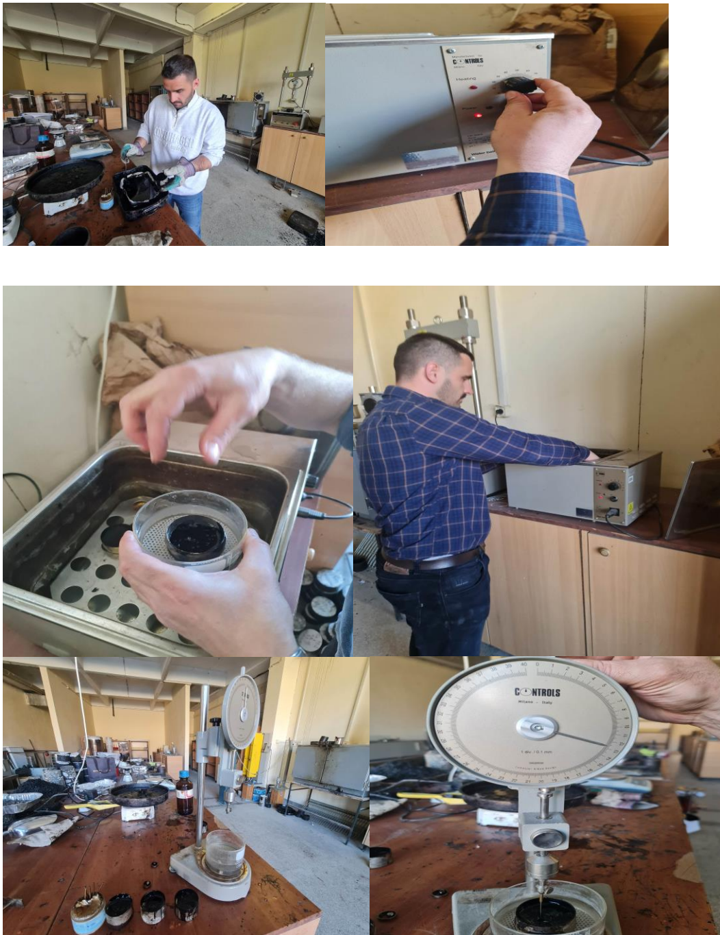
Fig.3.3 Procesi i shkrirjes dhe vendosja e bitumenit ne mostra
