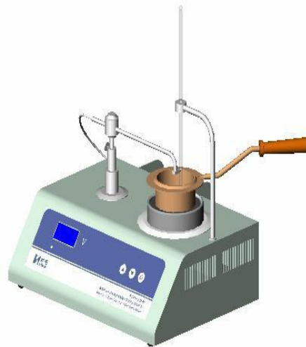
Fig.3.11 Aparati për të përcaktuar pikën e zjarrit dhe përflakshmerisë
