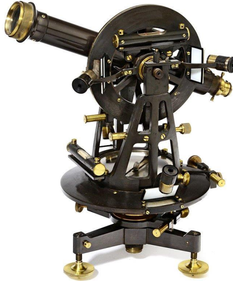
Fig.7. Teodolit mekanik me limbin vertikal te jashtem
