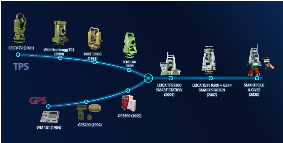
Fig.35. Zhvillimi gradual i Sistemit 1200 deri në Takiometer
