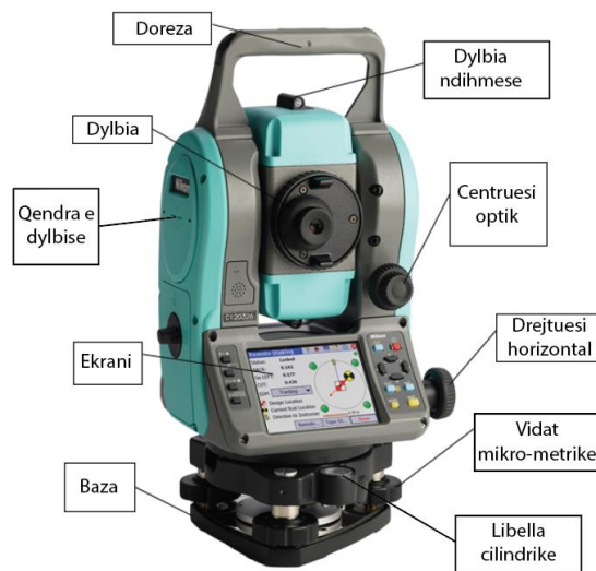
Fig.33. Përbërësit kryesorë të Takiometrit
