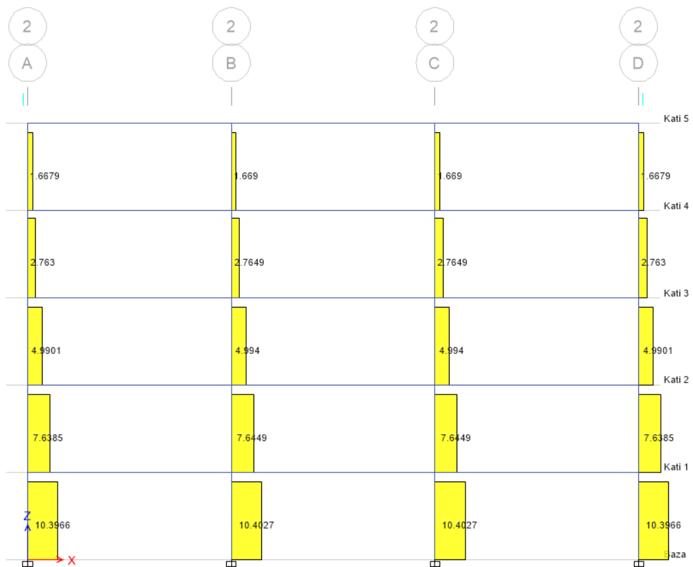
Figura 67: Diagrami i forcave aksiale ( N ) nga ngarkesat sizmike E_y në ramën 2-2
