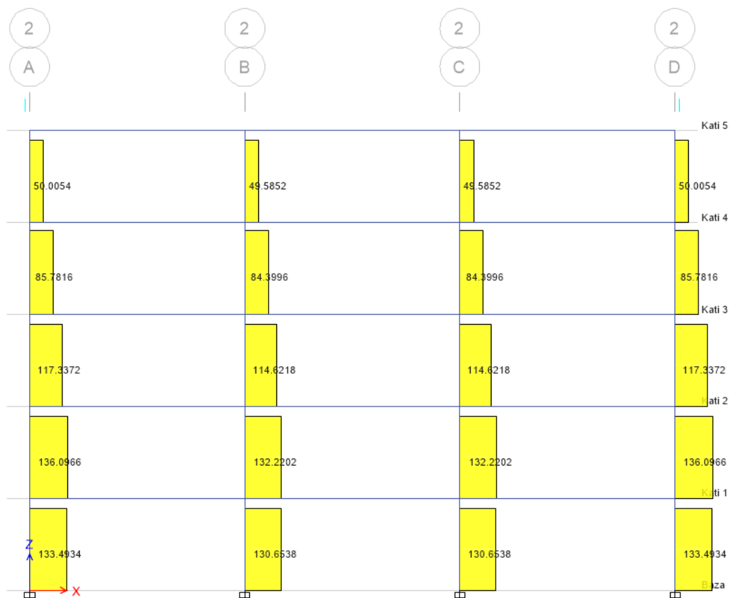
Figura 68: Diagrami i forcave transversale (T) nga ngarkesat sizmike Ey në ramën 2-2
