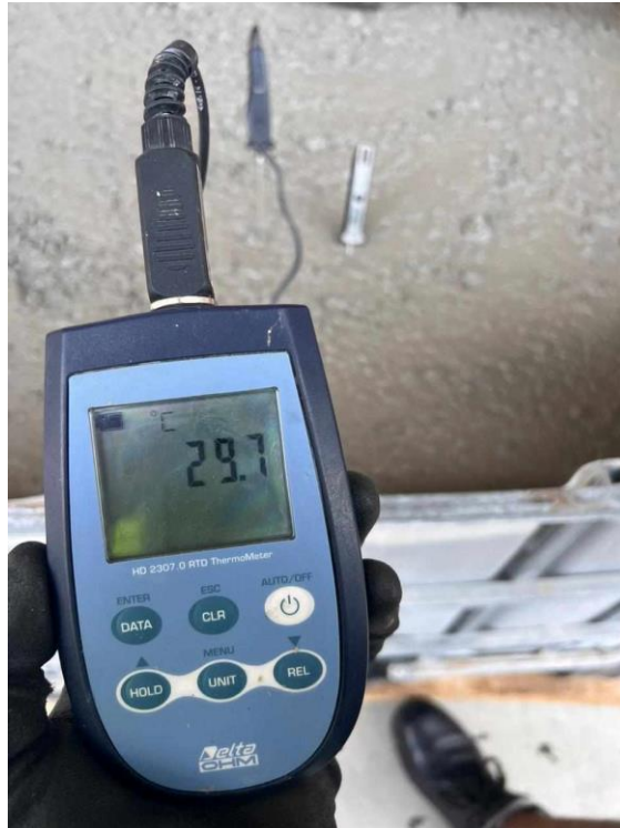
Figura. 60. Matja e temperaturës së betonit
