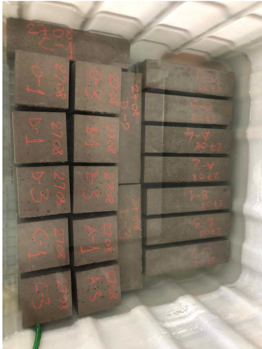
Figura. 62. Largimi i mostrave nga kallupet pas 24h dhe vendosja e tyre në ujë në temperatur 20 \pm 2^{\circ}\text{C}
