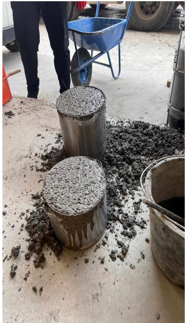
Figura. 56. Vendosija e sasisë së betonit në enë të posaqme me vëllim 0.040 \text{ m}^3
