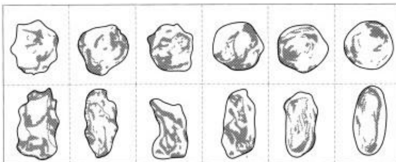
Figura. 16. Forma të ndryshme të agregateve
