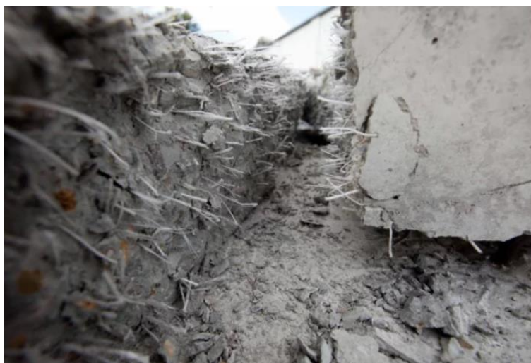
Figura. 2. Aplikimi I fibrave në beton
