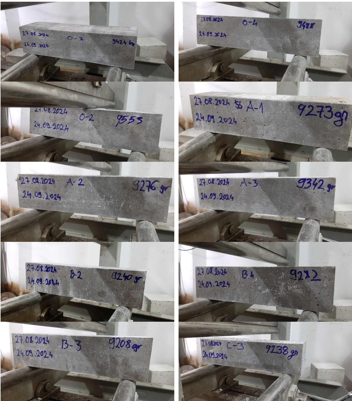
Figura. 80. Ekzaminimi 28 ditor i mostrave në përkulje
