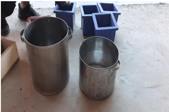
Figura. 56. Vendosija e sasisë së betonit në enë të posaqme me vëllim 0.040 \text{ m}^3
