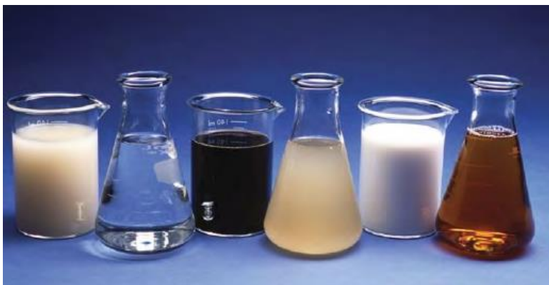
Figura. 22.Shtesat kimike nga e majta në të djathtë. Shtesa kundër larjes së çimentos, Shtesa për zvoglimin e tkurrjes, Reduktuesi i sasisë së ujit, Agjentë shumës për zvoglimin e densitetit të betonit, Ngadalsues të korrozionit, Përzierje për vendosje të ajrit në
