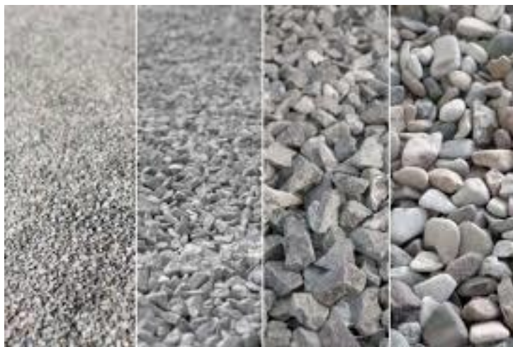
Figura. 17. Fraksionet e agregateve
