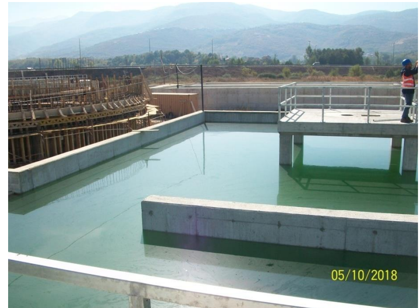
Testimi në rrjedhje i rezervoarit tertës aerobik
