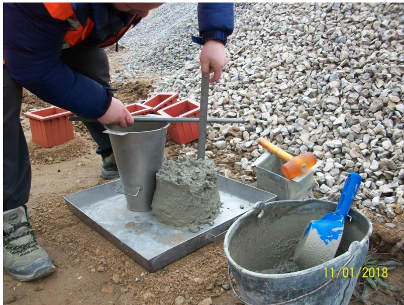
Kontrolla e konsistencës së betonit gjatë betonimit
