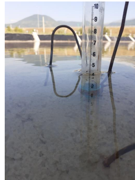
Testimi në rrjedhje i lagunave për tharjen dhe stabilizimin e llumit
